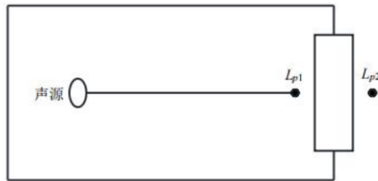
图4-1 室内声源等效为室外声源示意图
