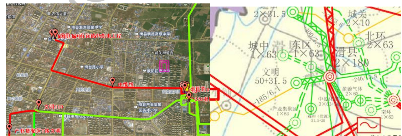
图 6-15 规划 110kV 城中变输电线路走廊图
