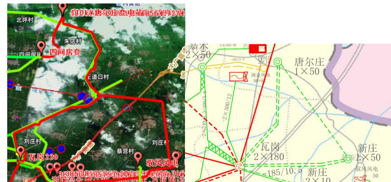
图 6-31 规划 110kV 唐尔庄变输电线路走廊图
