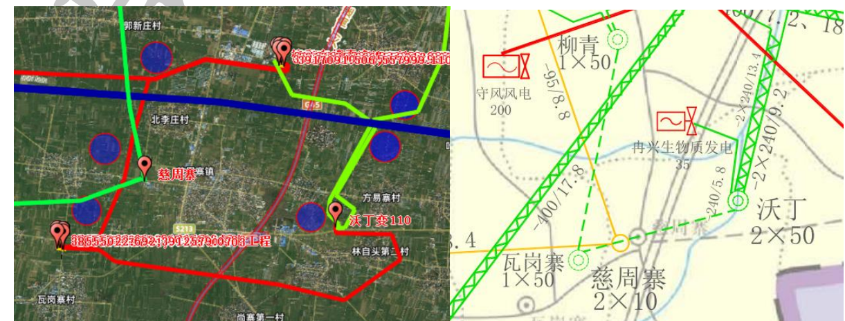
图 6-23 规划 110kV 瓦岗寨变输电线路走廊图
