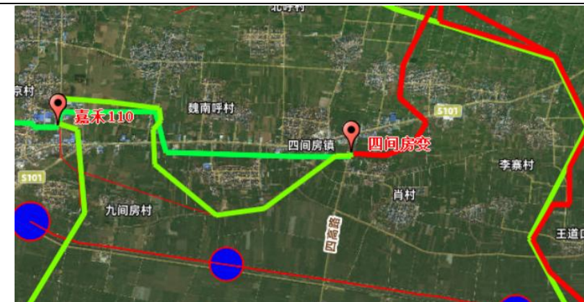
图 6-33 35kV 四间房变输电线路走廊图
