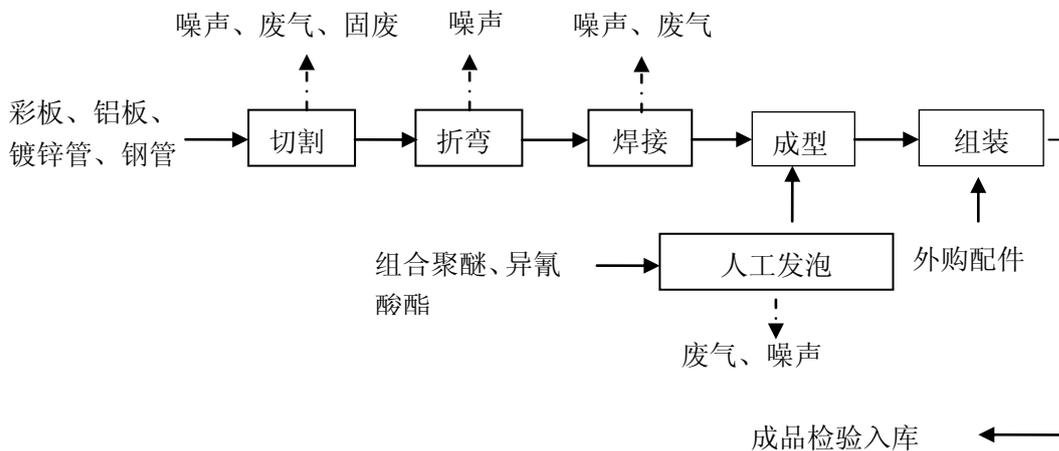
图 1 现有工程工艺流程及产污环节示意图
