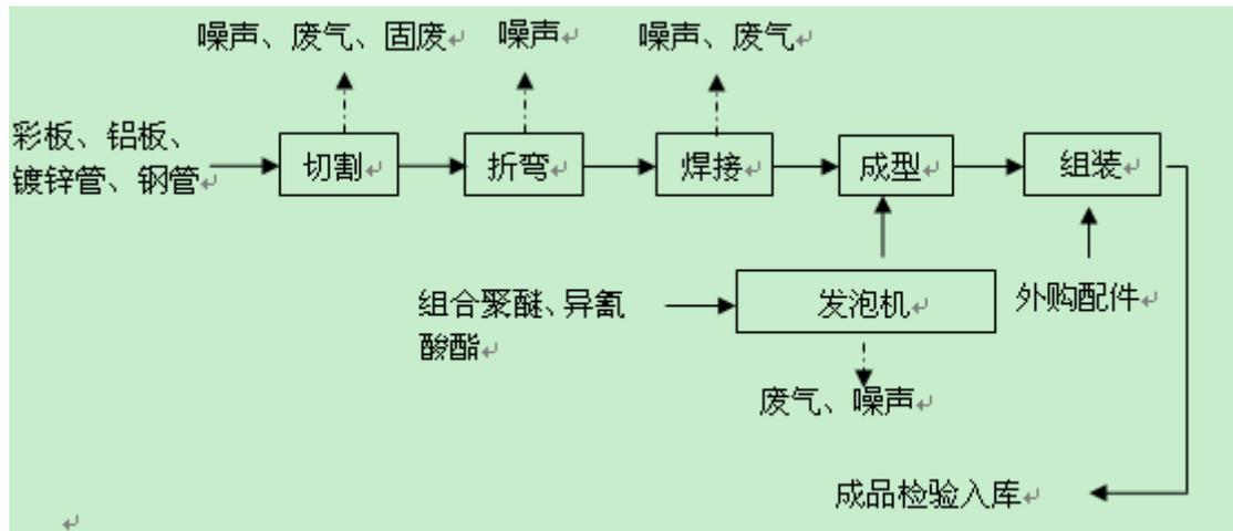
图2 项目工艺流程及产污环节示意图
